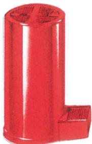
Z-319 トウリフト 重量物の持ち上げ、拡げ作業の際、RC-220ラムにつけて操作するアタッチメントです。トウの部分では25トンの持ち上げが出来ます。トウはスリーブから6.25cm出ています。厚さ5.6cm 幅7.5cmです。
