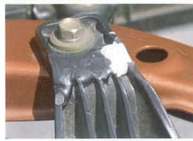
衝突時のライトステー折れ 針金と併用します。
