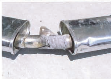
マフラー排気漏れ
