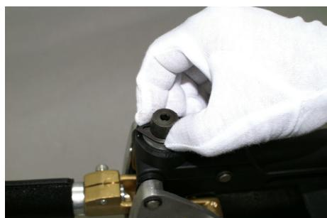
加圧調整ダイヤルの矢印が0位置（ポツチの所）より、ずれていたら、矢印を手で0位置に合わせる。
