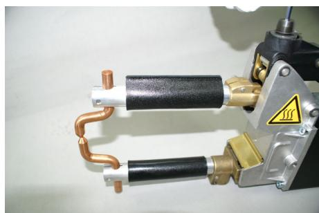
確認できたら加圧調整ダイヤルを右回し（目盛りの数が多い方向）に、チップとチップがつく、もしくは、ハンドルを握りながら片手でアームを持ち上げてチップを離すことが、できなくなるまで回す。
