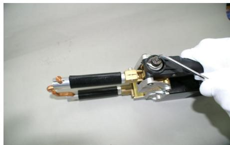
ハンドルを軽く握り、加圧調整ダイヤルに備え付けの六角レンチを差込み、左回し（目盛りの数が少ない方向）に回す。
