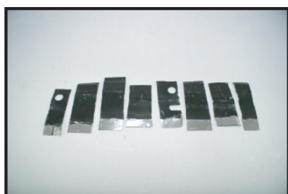
カットした端材をさらに半分 にし、アテ板の上でハンマー でたたきサフェーサーを剥が し、テストピースを作る
