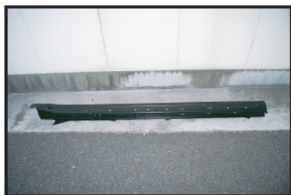
トヨタプリウス VW30 用 ロッカーパネル (980MP 級) 品番: 61404-47030 を入手
