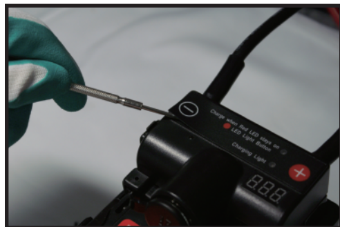
① マイナスの精密ドライバー等を使い、シールをはがします。
