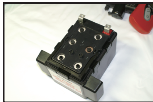
⑥ 6個すべてのゴムキャップを外します。
