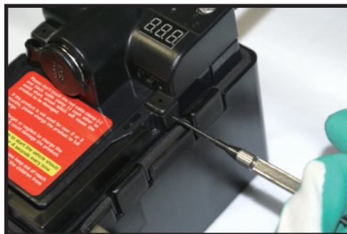
② プラスの精密ドライバーにて、両サイドのボルトを外します。
