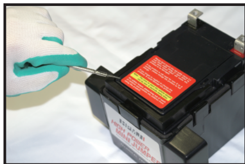
④ マイナスの精密ドライバーで、上カバーを外します。
