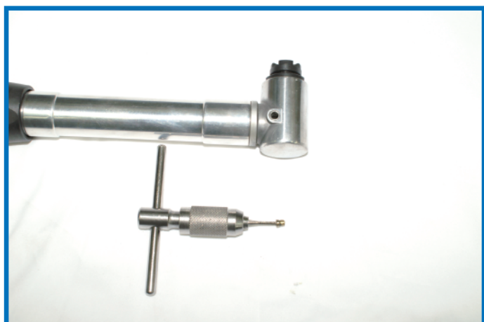
③ ネジ込んだ状態で上に引き抜けば簡単に抜けます。
