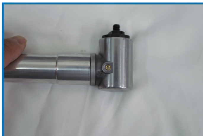
④ 新しいオイルプラグを指で挿入して完了です。
