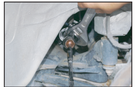
③ 回りにスペースが無く手前から斜めにモンキーで回そうとしても力が入らずとても作業が困難になります。
