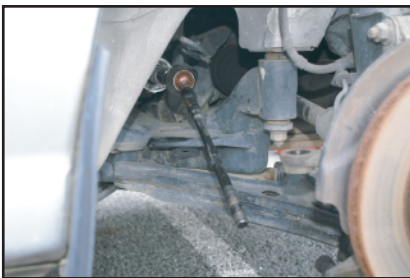
① タイロッドエンドを外した状態。
