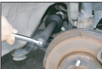
④ シャフトを包み込んでセットする為、回りにスペースが無くても簡単に回すことができます。
